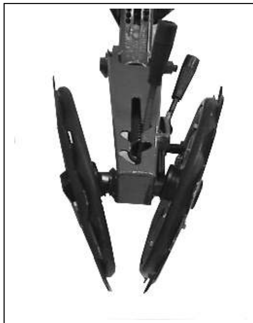
Figura 26: Ruedas de compactación - cobertura
