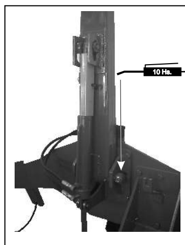
Figura 7a - 7b: Bujes de marcadores y de cilindros 10 surcos - 7 surcos.
