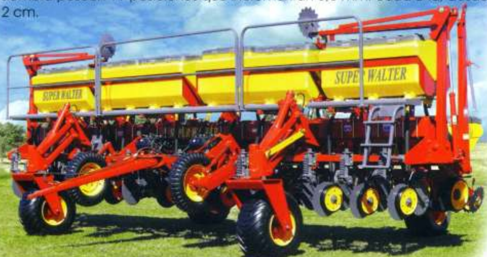
Sembradora Granos Gruesos de 10 surcos a 70 cm. Variable de 14 surcos a 52 cm. c/fertilizador
