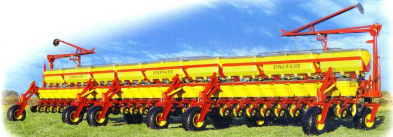
Sembradora Integrada de 3 módulos de 24 surcos a 70 cm. Variable a 30 surcos a 52,5 cm
