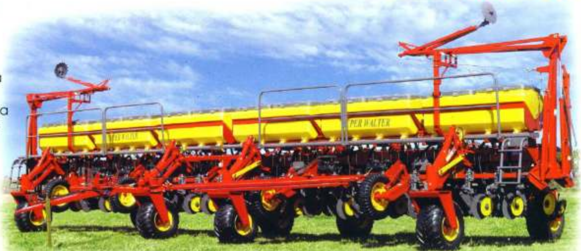
Sembradora Integrada de 2 módulos de 20 surcos a 70 cm. Variable a 24 surcos a 52,5 cm
