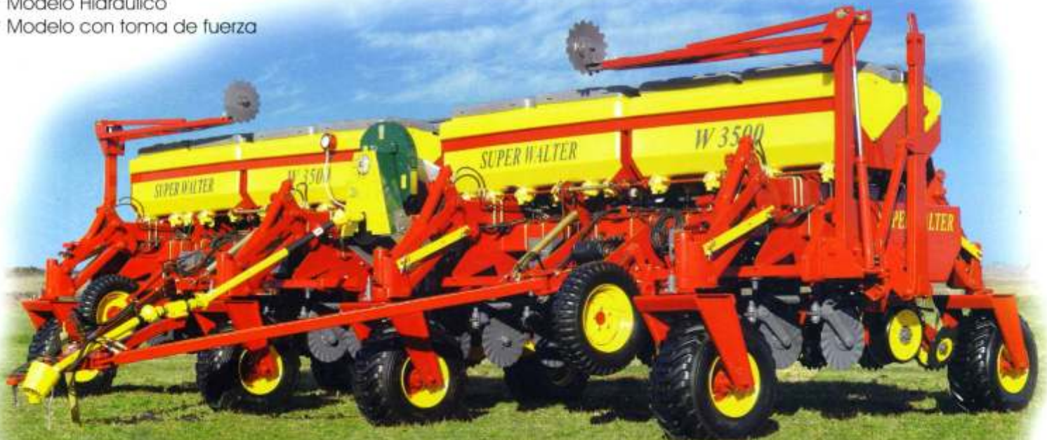
Sembradora Neumatica W3500. 16 líneas a 52,5 cm. Variable a 35, 45 cm, 52,5 cm, 70 cm y 100 cm
